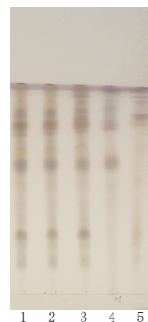
图5 枇杷叶的TLC鉴别图 1~3: 供试品(批号分别为190301、23210241、19090030); 4: 枇杷叶对照药材; 5: 阴性对照
